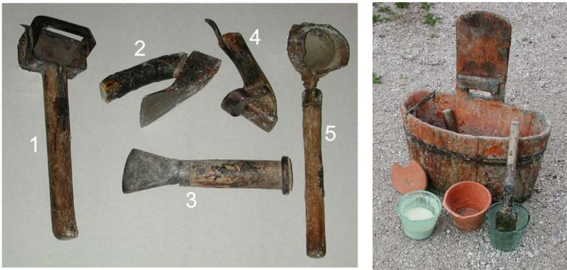
**Abbildung 3: Heute verwendete Werkzeuge: links: (1)Röteleisen oder Rintler zum Entfernen der Rinde, (2)Dixel zum Einsetzen der Leitspäne, (3)Anschlageisen für das Einschlagen der Nut für den Sammeltopf, (4)Piestinger Hobel, (5)Scherrpechkrazer; rechts: Pechpittel mit verschiedenen Sammeltopfen und dem Harzlöffel zum Ausschaben des Harzes aus dem Sammeltopf**
