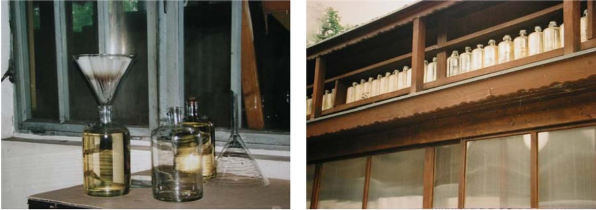
**Abbildung 10: Filtrieren (links) und Ausbleichen des „Jungfernharzes“ an der Sonne (rechts)**
